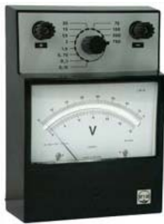
Rysunek 1 Analogowy woltomierz magnetoelektryczny.
